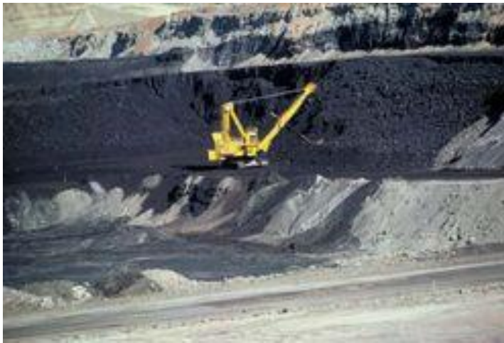
figura 3.2. Extração do minério por meios mecânicos
