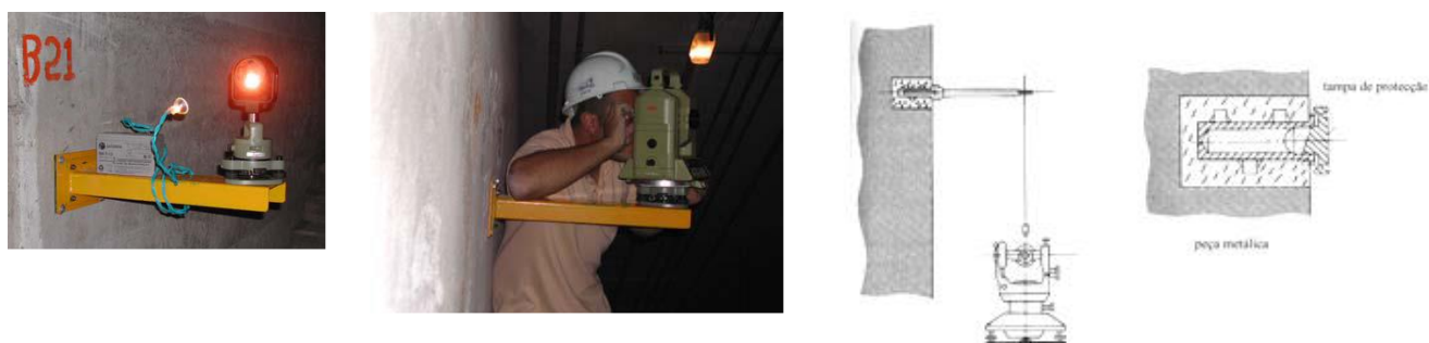
figura 3.13. Estacionamento sob uma marca na parede de uma mina
